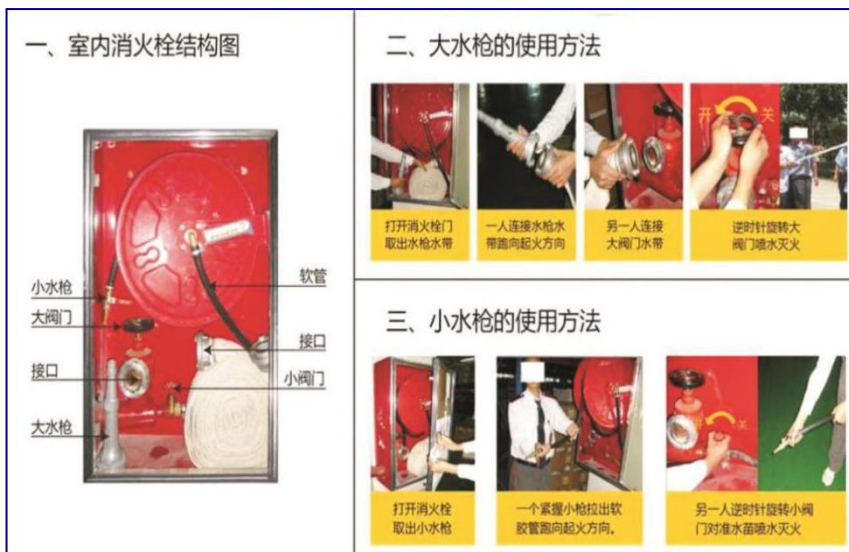
室内消火栓使用示意图
